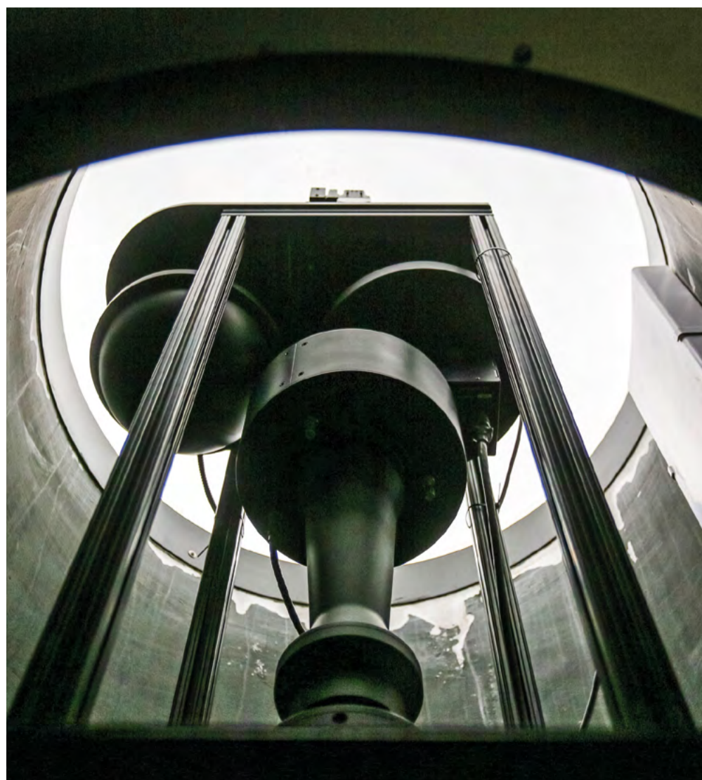
Подъемник, который выдерживает до 300 кг и поднимает под купол здания наблюдательную аппаратуру, сконструирован и сделан в ИСЗФ СО РАН
