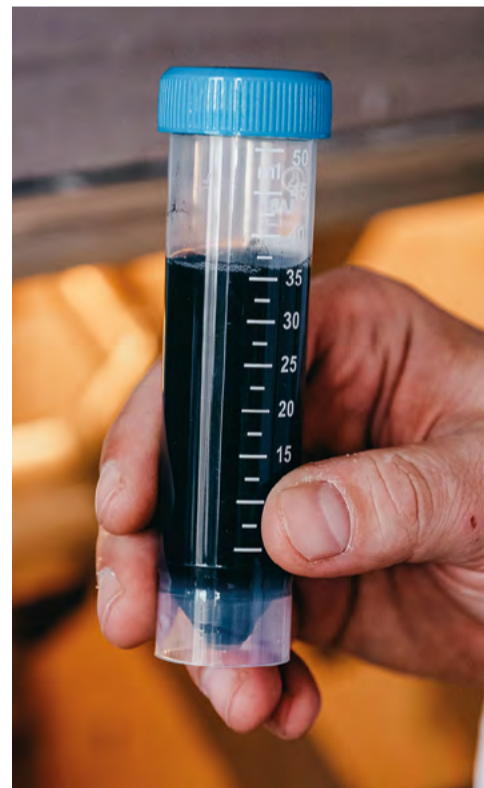
Готовый синтезированный материал двумерных сульфидно-гидроксидных наночастиц в растворе
