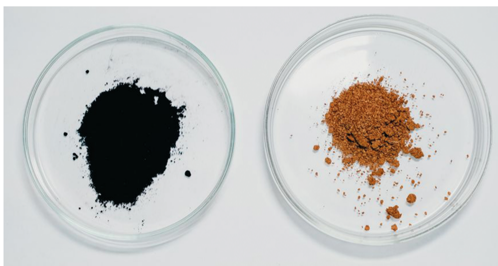
Углеродный продукт (слева), полученный из коры сосны (справа)
