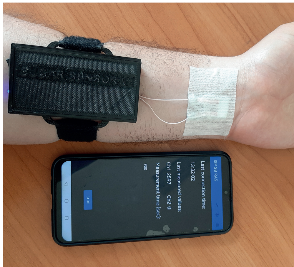
Измерение содержания глюкозы в поту неинвазивным сенсором
