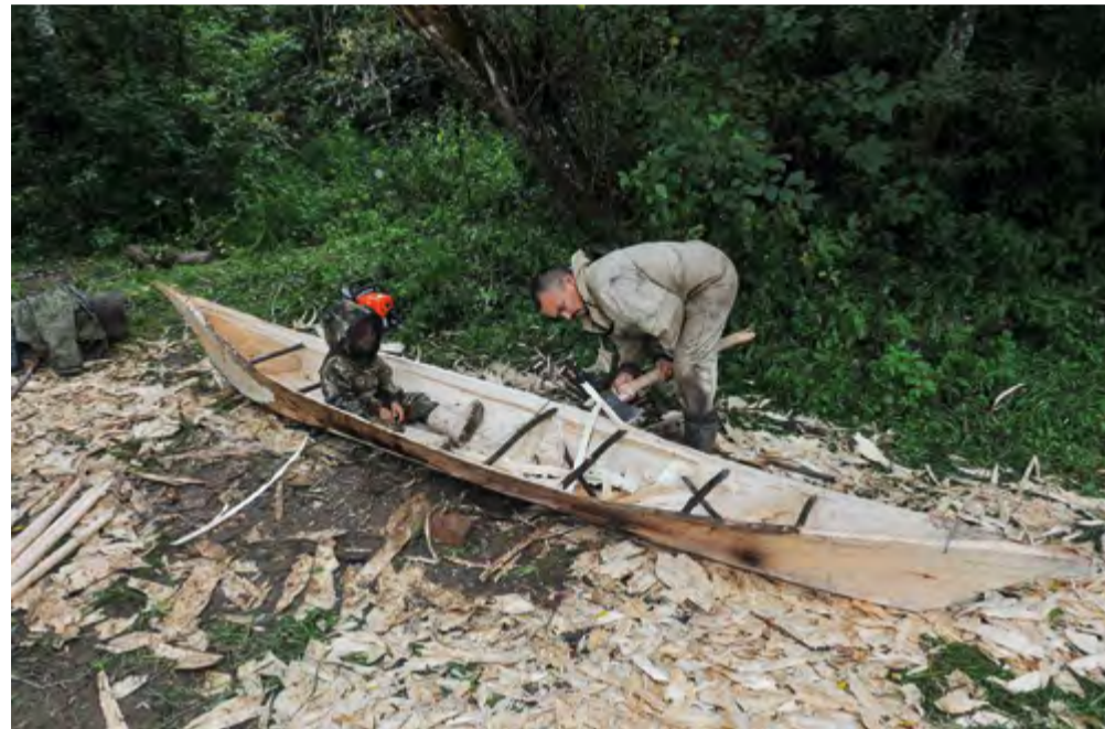
Так вставляют распорки для расширения бортов лодки
