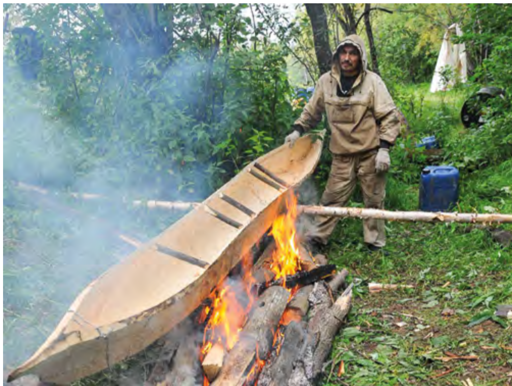
Процесс нагрева лодки над костром и ее расширения с помощью распорок
