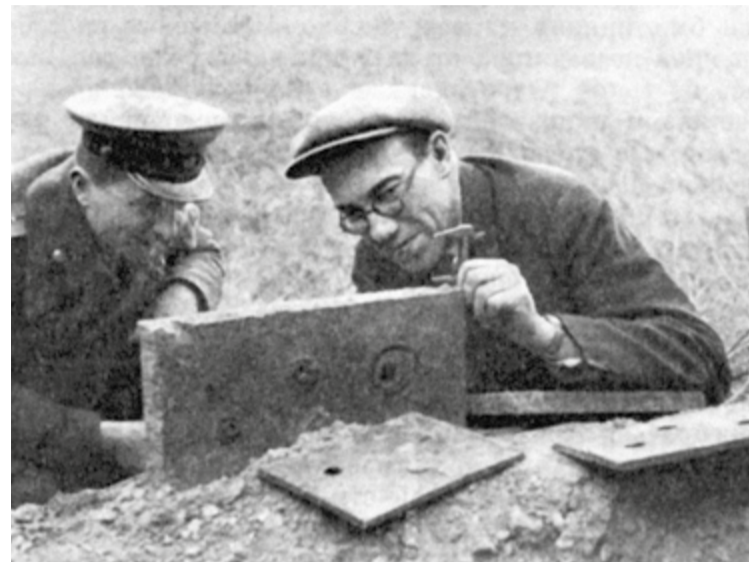
Исследование пробивания танковой брони, 1944 год
