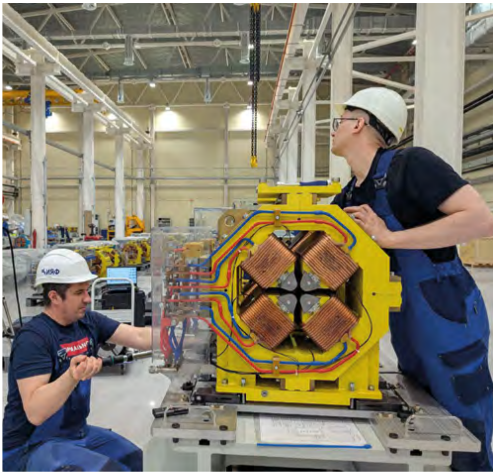
Геодезисты ИЯФ СО РАН проводят гирдерную сборку
