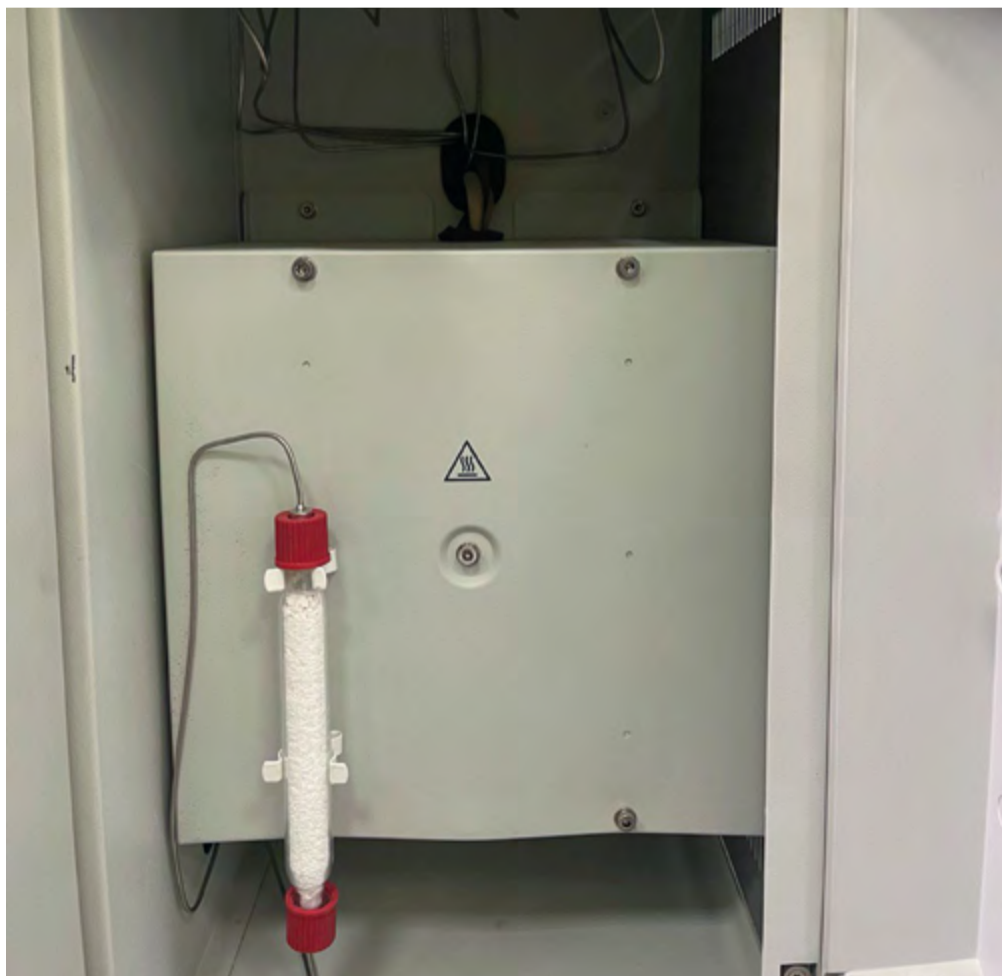
Элементный анализатор Thermo Flash 2000. Его используют для превращения твердого образца в газ для изотопного анализа
