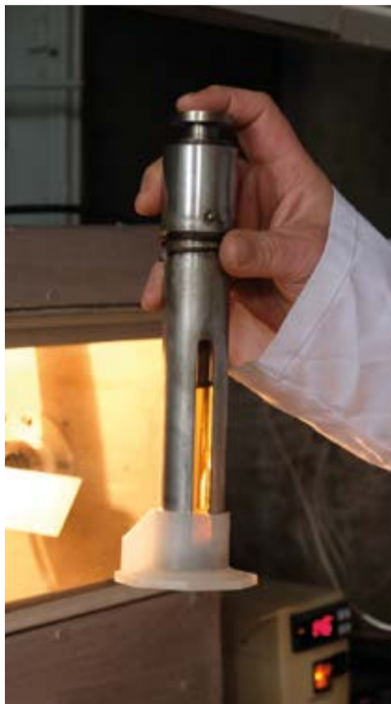
Кварцевый лабораторный автоклав в стальном кожухе, используемый для изучения кинетики растворения порошков
