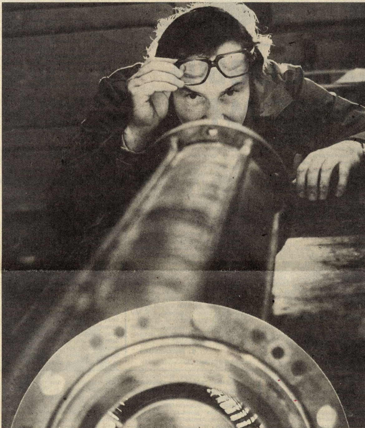
Институт ядерной физики Сибирского отделения АН СССР. Научный сотрудник Геннадий СЕРДОВИЦЕВ контролирует качество обработки поверхности структуры линейного ускорителя-инжектора для источника синхротронного излучения «Зеленоград».
