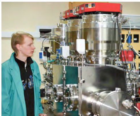
Универсальный стенд КЛИУС для обработки материалов ионно-кластерным пучком
