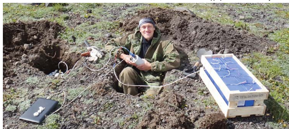
Установка сейсмодатчиков. Фото А. В. Яковлева
