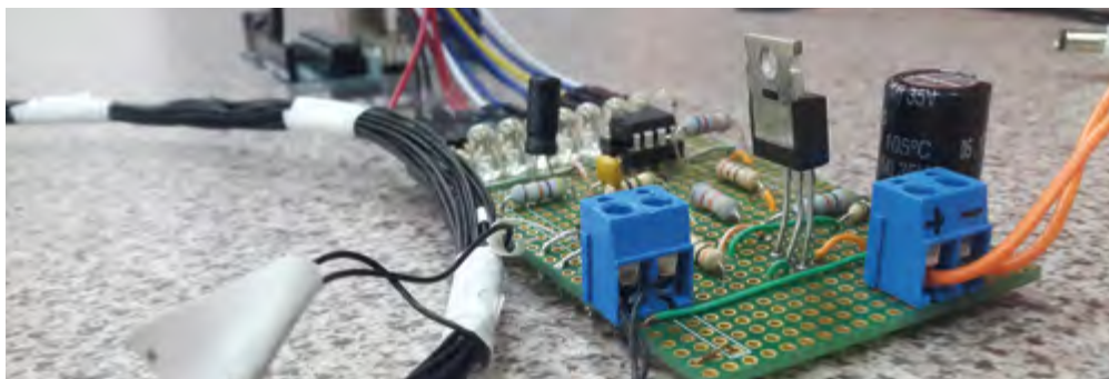
Однокатушечный металлоискатель индукционного типа, разработанный Александром Сыпченко и Владиславом Симоненко
