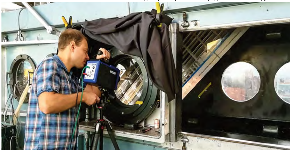
Подготовка тепловизионной камеры к диагностике течения в аэродинамической трубе Т-324 ИТПМ СО РАН (кандидат физико-математических наук Д. А. Мищенко)
