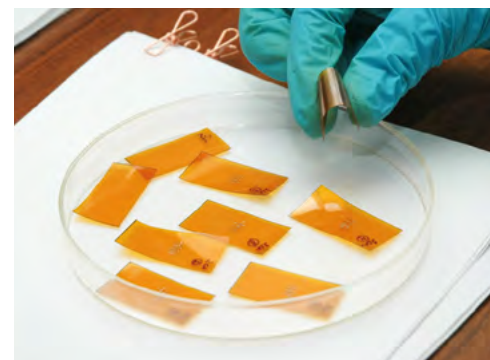
Мемристорные структуры, напечатанные на гибкой полимерной пленке в ИФП СО РАН
